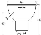
**Technische Daten Osram Parathom Retrofit Led-Spot GU10 PAR16 5W 250lm 120D - 827 Extra Warmweiß | RGBW - Dimmbar - Fernsteuerung - Ersatz Für 25W**
