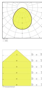
Technische Daten Ledvance LED-Scheinwerfer Sensor GEN 3 Schwarz 50W 5500lm 100D - 830 Warmweiß | IP65 - Bewegungs- und Lichtsensor - Symmetrisch - Ersatz für 100W
