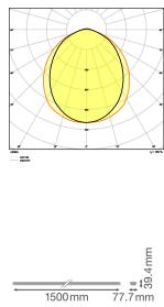
**Technische Daten Ledvance LED Tragschiene Trusys Flex Opal Stahl Weiß 50W 8300lm 90D - 840 Kaltweiß | 3 Stunden Notbeleuchtung**
