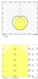
Technische Daten Ledvance LED Röhre T8 Performance (EM/Mains) Ultra Output 16W 2400lm - 840 Kaltweiß | 120cm - Connected - Ersatz für 36W
