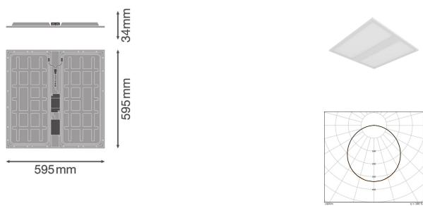
Technische Daten Ledvance LED Panel Protect 36W 5040lm - 840 Kaltweiß | 60x60cm - UGR <22 - Zigbee Dimmbar
