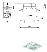
Technische Daten Philips LED Downlight LuxSpace Quadrat DN572B 16.5W 2200lm 80D - 830 Warmweiß | 214mm - Aluminium Reflektor
